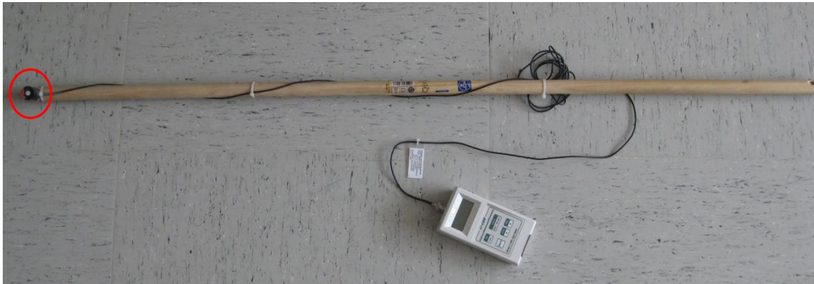
Abb. 11: Punktsensor (roter Kreis; LI-190 Quantum Sensor; Fa. Li-Cor ® , Lincoln, Nebraska, USA) montiert auf einem Holzstab mit Datenspeicher (LI-250 Light Meter, Fa. Li-Cor ® , Lincoln, Nebraska, USA).
