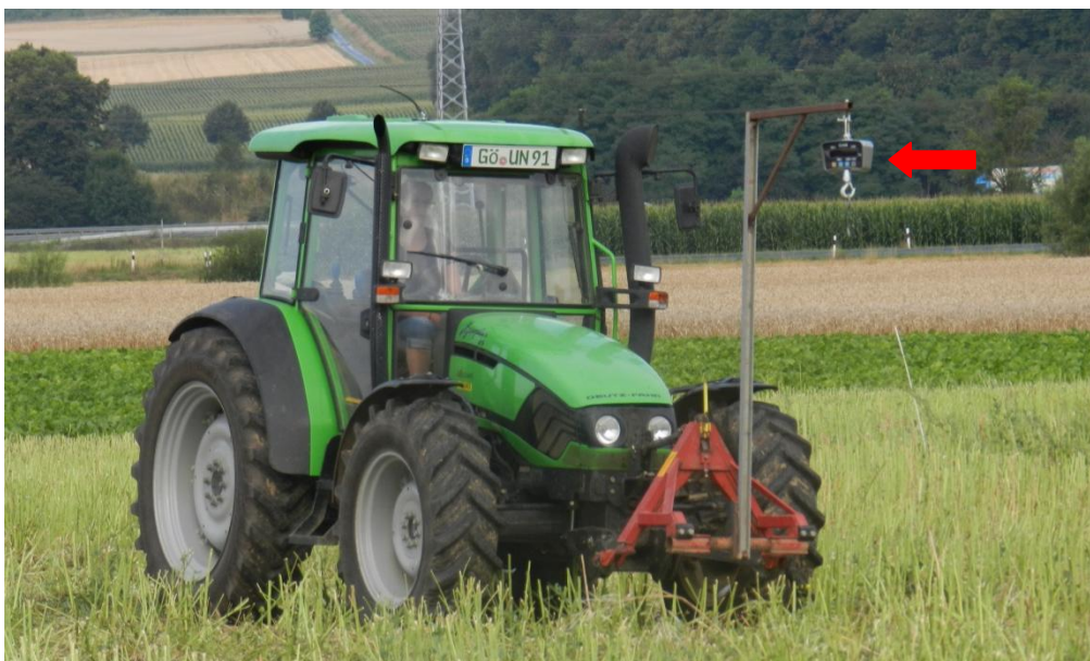
Abb. 18: Schlepper (Modell Agropius 85, Fa. Deutz-Fahr, Köln) mit Anbauvorrichtung in der Fronthydraulik an der die Hängewaage (roter Pfeil) befestigt war.
