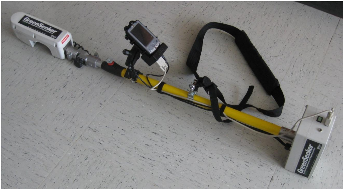
Abb. 14: GreenSeeker ® von der Firma NTech ® Industries. Links: Sensoreinheit, in der Mitte: Personal Digital Assistant (PDA), auf dem die Normalized Difference Vegetation Index (NDVI)-Werte gespeichert werden und rechts: Akku.
