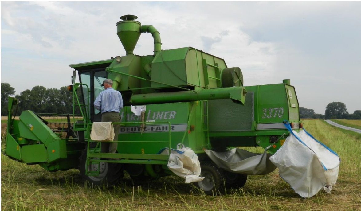
Abb. 17: Mähdrescher (Modell Farmliner 3370, Fa. Deutz-Fahr, Köln) für die Parzellenernte mit einer Auffangvorrichtung für Spreu (graue Plane) und einer Auffangvorrichtung für das gehäckselte Rapsstroh [weißer flexibler Schüttgutbehälter (Big-Bag)].
