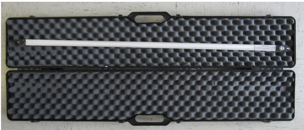
Abb. 10: Aufsicht auf den 1 m Stabsensor (LI-191 Line Quantum Sensor, Fa. Li-Cor ® , Lincoln, Nebraska, USA) in aufgeklappter Transportbox.
