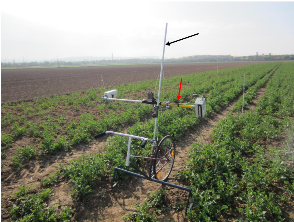
Abb. 16: GreenSeeker ® (roter Pfeil) montiert an ein selbstkonstruiertes, fahrbares Gestell. Der GreenSeeker ® kann individuell an der senkrechten Stange (schwarzer Pfeil) in der Höhe verstellt werden.
