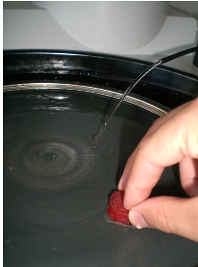
Abbildung 3.2: Politur der Prüfkörper
