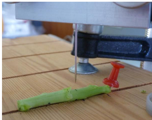
Abb. 4 Analyse der Gewebestabilität von Rapsstängel über die Druck-Kraftmessung des Texture Analysers TA-XT2®.
