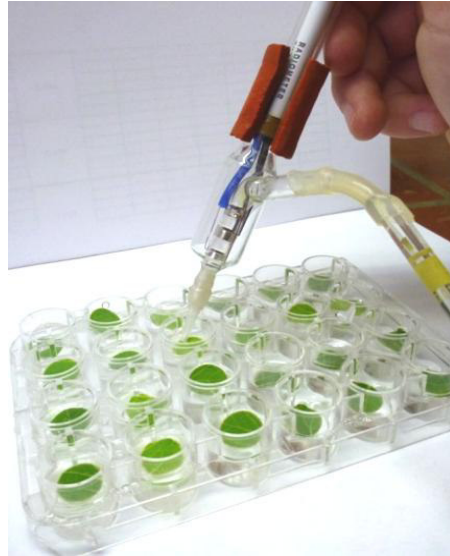
Abb. 3 Bestimmung der Leitfähigkeit nach Inkubation der Blattscheiben mit Oxalsäure durch Einsaugen des bidest. Wassers in die Messelektrode des Leitfähigkeitsmessgerätes.
