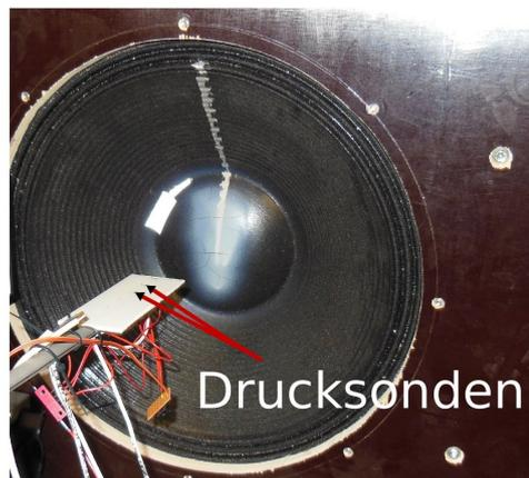
Abbildung 7.13.: Versuchsaufbau für die Messung des Druckgradienten mithilfe von zwei Drucksensoren im Abstand von 2 cm.
