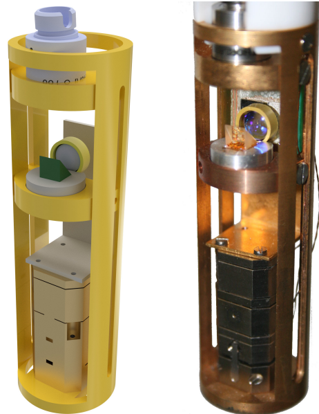
Abbildung 3.10.: CAD-Zeichnung und Foto des Messkopfes. In dem vergoldeten Kupferkäfig befinden sich zwei in der Höhe verschiebbare Plattformen, von denen die obere einen Kollimator trägt, an den die Glasfaser angeschlossen werden kann; die untere einen Drehteller mit 90°-Spiegel und Linse. Die auf den L-Halter gesteckte Probe kann mit den darunter liegenden piezoelektrischen Motoren in den drei Raumrichtungen verfahren werden.
