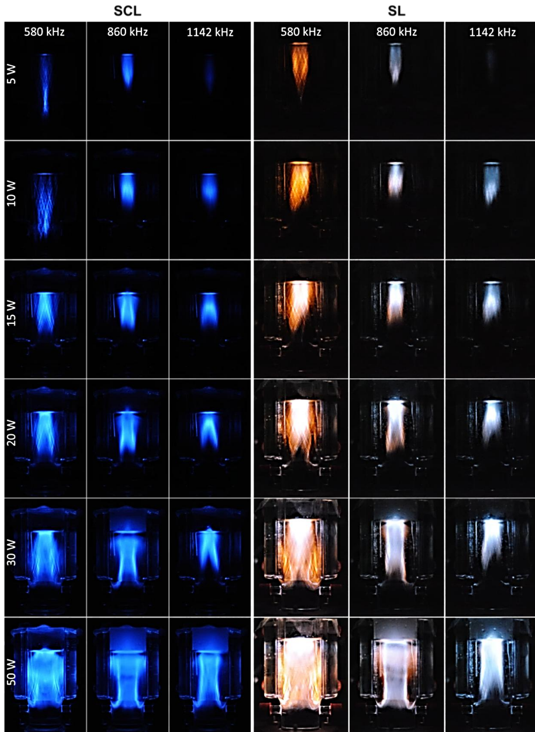
Abbildung 5.11: SCL-Aufnahmen (links, ISO-4000, 15 s Belichtungszeit) und SL-Aufnahmen (rechts, ISO-25600, 30 s Belichtungszeit) im Ultraschallreaktor für die elektrolytische Kupferabscheidung ohne Anoden und ohne Substrat; die elektrische Leistung variiert von 5 bis 50 W für die verwendeten Frequenzen (580, 860 und 1142 kHz).
