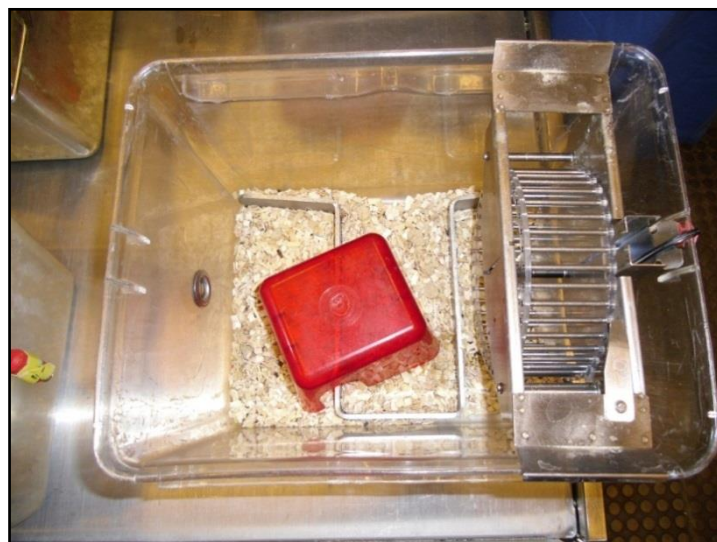
Abbildung 6: Käfig mit Streu, Streu, Häuschen und Laufrad mit Sensor
