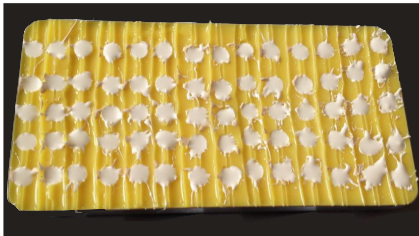
Abbildung 17: Form aus Dubliersilikon mit ausgehärteten Probekörpern.
