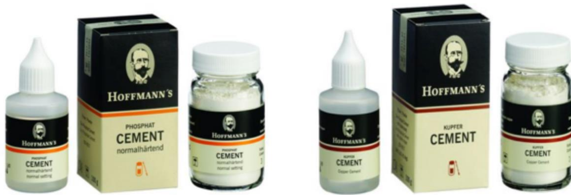
Abbildung 16: Testzemente: Kupferfrei (links) und kupferhaltig (rechts).
