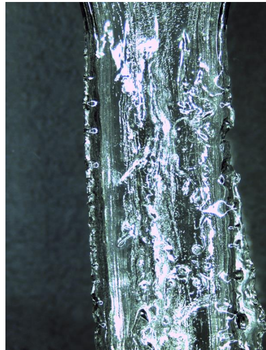
Abbildung 4-9 Lichtmikroskop-Aufnahme von einem Steg eines Zugversuch-Probekörpers eines konventionellen Poly(BA- co -BDDA)-Netzwerks mit einem molaren Anteil von 2 mol-% BDDA.
