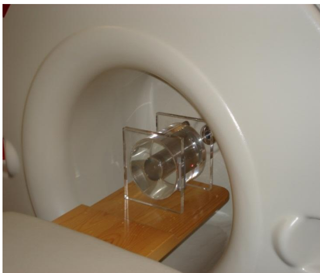
Abb. 8: Prüfkörper für die Konstanzprüfung des NewTom QR-DVT 9000©
