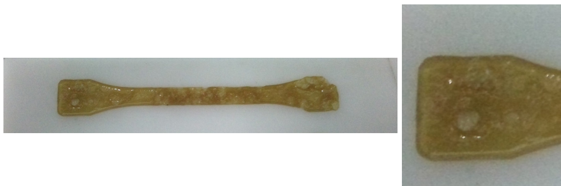
Abb. 6.16: Probekörper des vernetzten Polymers PR-03 nach dem Trocknen. Die Lufteinschlüsse die beim Trocknen entstanden sind, sind deutlich zu erkennen (siehe vor allem Vergrößerung im rechten Bild).
