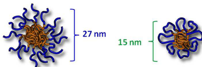
Abb. 2.7: Mizellenbildung gleichlanger linearer und zyklischer Diblockcopolymere aus Poly(Ethylenglycol- b -Caprolacton). Nachdruck mit freundlicher Genehmigung von Zhang et al. [90] . Copyright 2013 American Chemical Society.
