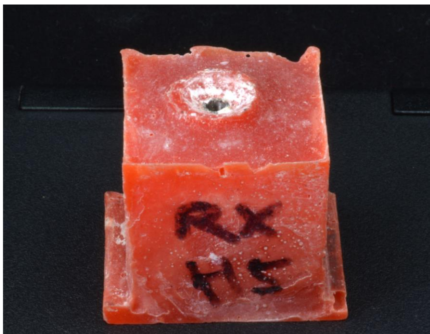
Abb. 18: Frakturierte Implantat-Abutment-Verbindung bei RelyX™ Unicem
