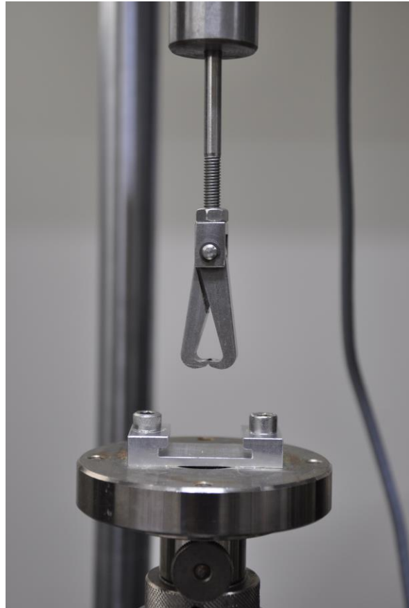
Abb. 17: Schematische Darstellung und Foto der Zwick-Universalprüfmaschine Z007 (Zwick, Ulm) mit Abzugskralle und Aufnahmeplattform
