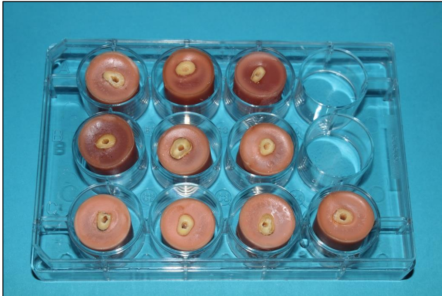
Abb. 5: Prüfkörper einer Gruppe gelagert in einer zwölfkammrigen Multischale
