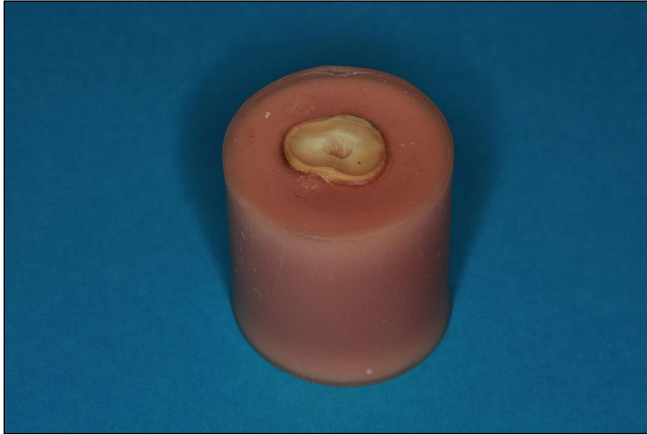
Abb. 4: Eingebettete Zahnwurzel in einem Zylinder aus Paladur® (Prüfkörper)
