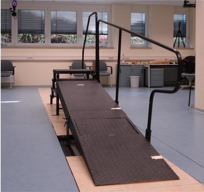
Abb. 4.4: über der Gehbahn aufgebaute Rampe mit 10° Neigung
