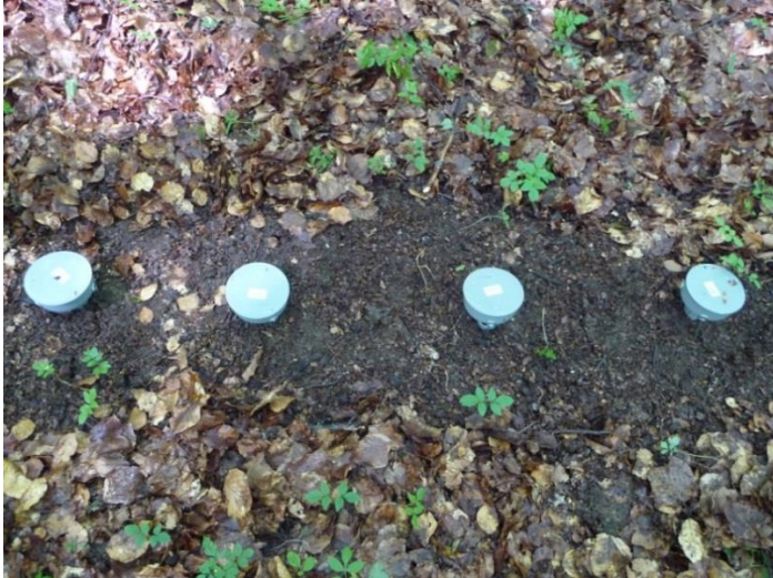
Abbildung 2.2.5: Abdeckung der markierten Stellen zum Schutz vor Regen
