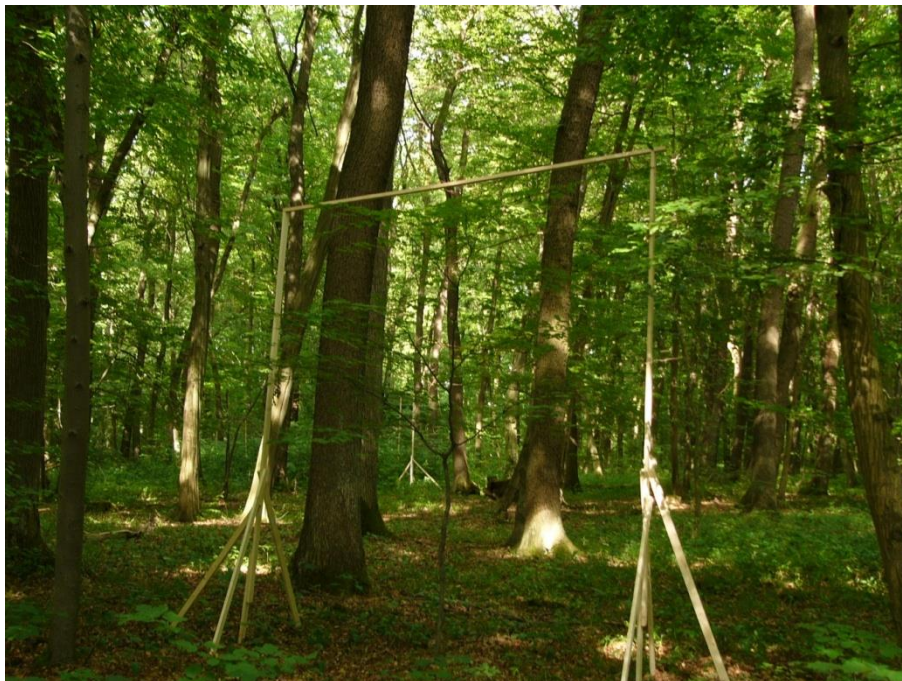
Abbildung 3.2.3: Holzkonstruktion zur Installation des Kunststoffschlauches (Fotos: S. Zieger)
