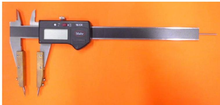
**Abbildung 24:** Messschieber 16EX, Mahr GmbH, Esslingen
