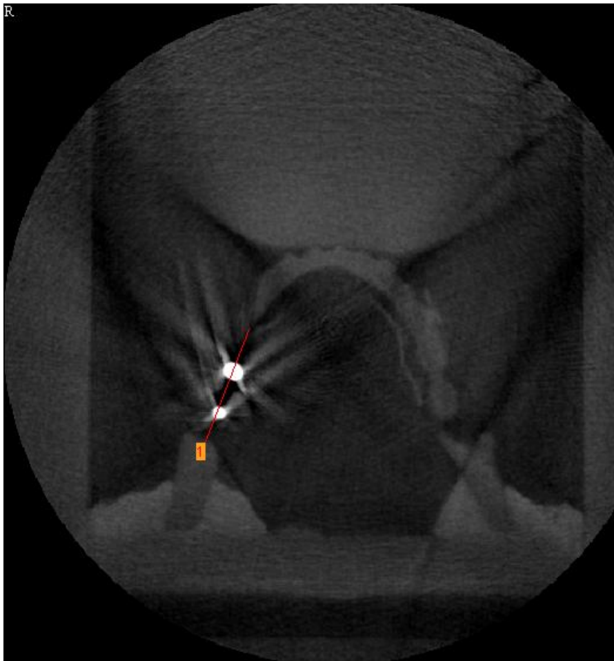
Abb. 17: Sagittaler Schnitt durch die crestal platzierten Kugelmarker auf dem Unterkiefermodell
