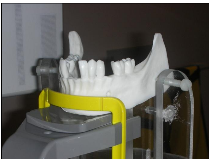
Abb. 2: Ursprüngliches Röntgenmodell fixiert auf Fotostativ im digitalen Panoramaschichtgerät Orthophos XG Plus
