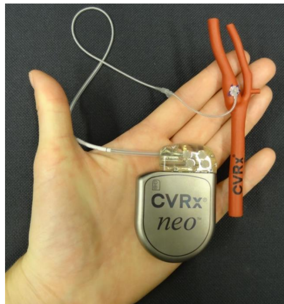
Abbildung 6: Das Aggregat in Originalgröße inklusive eines Modells der Karotisgabel; zu erkennen ist die auf die Halsschlagader genähte Elektrode, die über ein Verbindungskabel mit der Batterie konnektiert ist.
