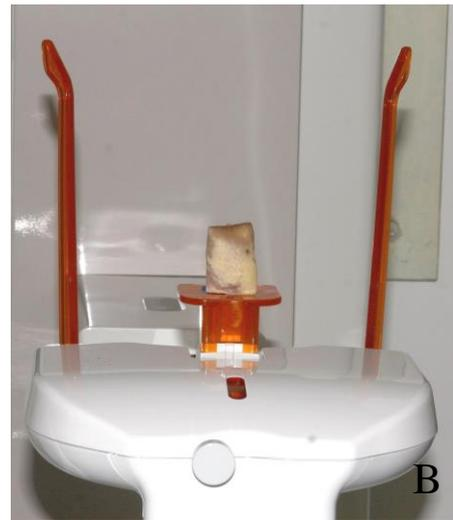
**Abbildung 3:** A und B: Versuchsaufbau DVT (PaX-Zenith 3D, Orangedental-Vatech, Südkorea). Dargestellt ist das Schweinekieferpräparat auf der Kinnstütze des DVT-Gerätes. Es ist zentral positioniert, sowie mit Hilfe von Periphery-Wachs senkrecht zur Unterlage ausgerichtet. Abb. A zeigt die senkrechte Positionierung durch das Periphery-Wachs (Pfeil), Abb. B zeigt das Präparat von der vestibulären Seite auf der Kinnablage.
