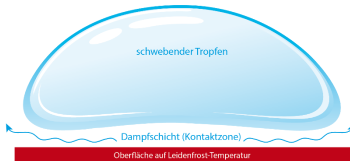
Abbildung 87 – Schematischer Aufbau eines Leidenfrost-Tropfens.
