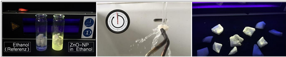
Abbildung 68 – Eingelegte Zwiebelproben in Ethanol und in eine Zinkoxid-Nanopartikel-Dispersion(links); Abspülen der Zwiebelstücke unter fließendem Wasser (mitte); Zwiebelproben nach dem Abspülen unter UV-Licht (rechts).
