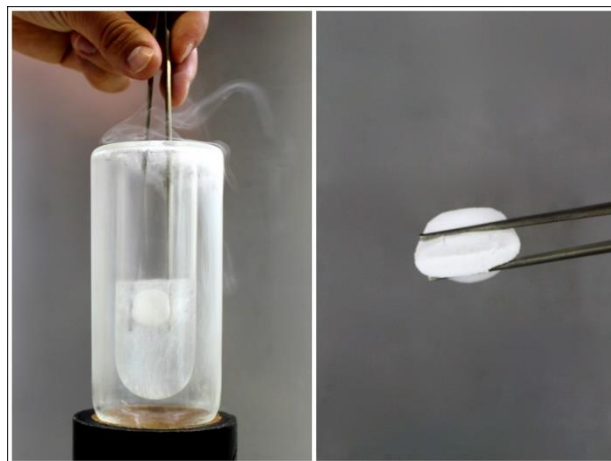
Abbildung 127 – Silikonschwamm in Flüssigstickstoff (links) und anschließender Flexibilitätstest (rechts).
