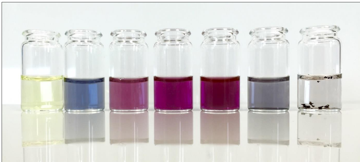
Abbildung 97 – Im Leidenfrost-Reaktor synthetisierte Gold-Nanopartikel. Illustrierter Übergang von der submikroskopischen Ebene (Gold-Ionen, links außen) über die Mesoebene (Gold-Nanopartikel, mitte) bis hin zur Stoffebene (ausgefallenes Gold, rechts).
