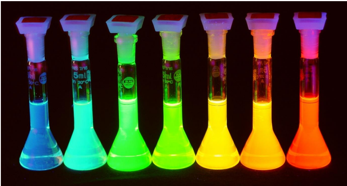
Abbildung 16 – Fluoreszenz von Cadmiumselenid-Nanopartikeln mit unterschiedlichen Partikelgrößen zwischen 2 nm (links) und 8 nm (rechts) [108] .
