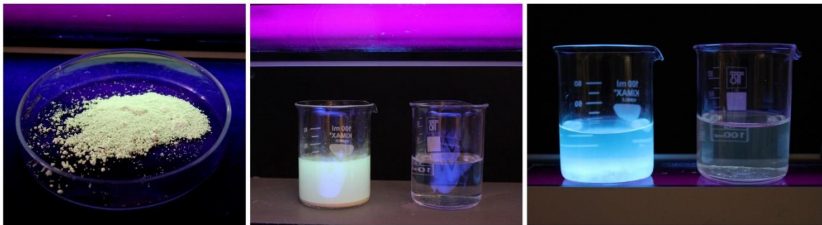
Abbildung 64 – Links: Eingedampfte Zinkoxid-Nanopartikel. Mitte: Cumarinlösung mit Zinkoxid-Nanopartikeln (linkes BG) und ohne (rechtes BG). Rechts: Filtrierte Lösungen unter UV-Licht.
