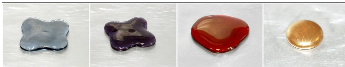
Abbildung 95 – Reaktionsstadien der Gold-Nanopartikel und des Goldes im Leidenfrost-Tropfen.
