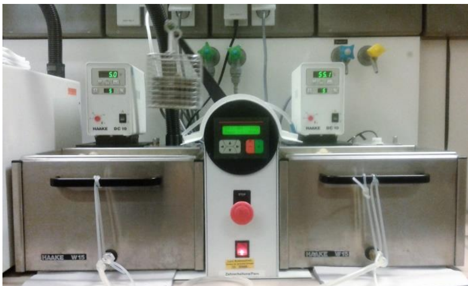
Abbildung 4.3: Thermischer Lastwechsler: In der linken Tauchwanne herrscht eine Temperatur von 5 °C, in der rechten Tauchwanne eine Temperatur von 55 °C. Am Schwenkarm ist eine Halterung mit einem Sieb befestigt, in dem sich die Prüfkörper befinden und abwechselnd in die Bäder getaucht werden.
