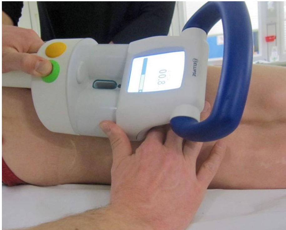
Abbildung 4: MAGEC® External Remote Controller der Firma Ellipse Technologies (Ellipse Technologies, Inc., Irvine, California, USA). (Fotographie erstellt von Dr. H. Lorenz, Arbeitsgruppe Kinderorthopädie, UMG, 2017)
