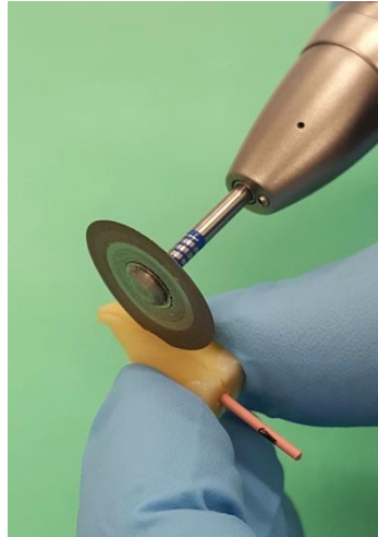
Abb. 4-2: Zahn beim Fräsen der vertikalen Rille mit einer diamantierten Trennscheibe
