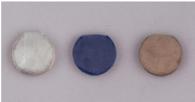
Abbildung 12: Testoberflächen (von links: Silberbeschichtung, unbeschichtetes Gummi, Bismutbeschichtung)
