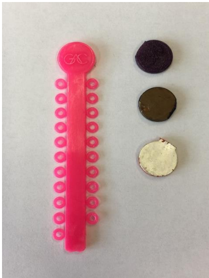
Abbildung 11: links: Polyurethan-Polyester-Elastomer-Sticks; rechts: Probestkörper, gewonnen aus den Endstücken der Sticks; von oben: unbeschichtet, mit Bismutbeschichtung, mit Silberbeschichtung
