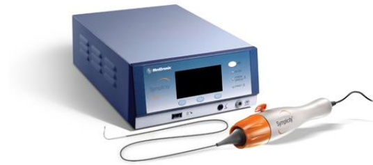
Abbildung 4. Behandlungskatheter für die individuelle Steuerung und Generator zur automatischen Energieabgabe
