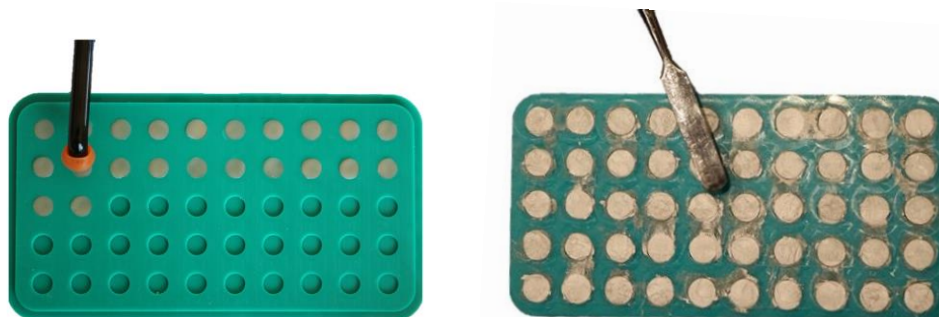
Abbildung 5: Polymerisation der Komposit-Probekörper (links) und Herstellung Amalgam-Probekörper (rechts)
