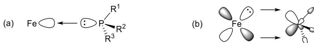
**Schema 12.** Darstellung der Bindungsinteraktionen zwischen Eisenzentrum und Phosphanligand mit den beteiligten Orbitalen: (a)  $\sigma$ -Donor-Bindung; (b)  $\pi$ -Rückbindung.<sup>[83a]</sup>
