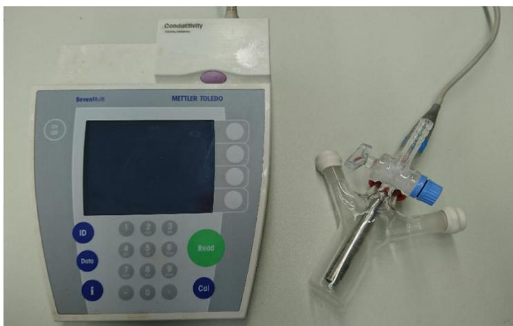
**Abbildung 81.** Seven Multi Instrument (Mettler Toledo) mit Edelstahlelektrode in Schlenk-fähiger Messzelle zur Messung der spezifischen elektrischen Leitfähigkeit  $\kappa$  von hydrolyse- und oxidationsempfindlichen Probenlösungen.
