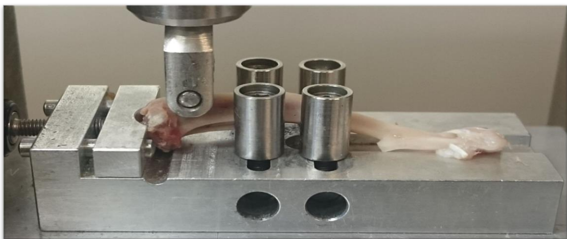
Abbildung 8: Positionierung der Tibia in der Prüfmaschine. Die vier Zylinder halten den Knochen in Position, während der Stempel von oben die gewählte Kraft ausübt. Es handelt sich um eine nichtostotomierte Tibia aus der Validierung
