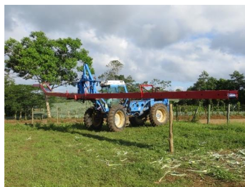
Abbildung 110: Erntemaschinenprototyp mit ausgeklapptem Ernteband
