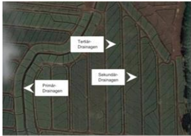
Abbildung 26: Drainagesystem eines Ananasfeldes nach EARTH, 2009
