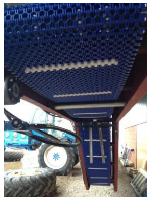
Abbildung 105: Erntemaschinenprototyp – Steigungsbereich des Förderbandes
