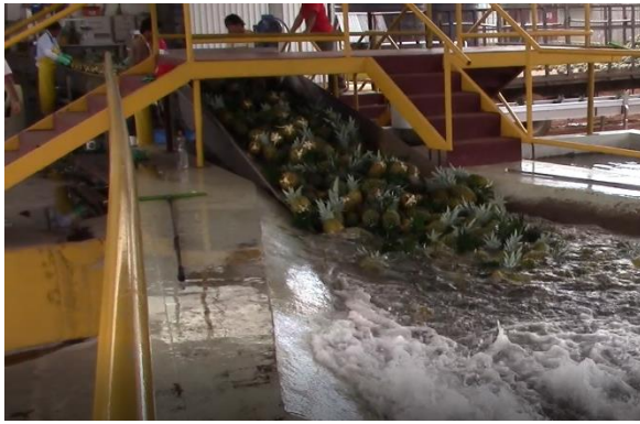
Abbildung 44: Annahmebecken der Packstation
