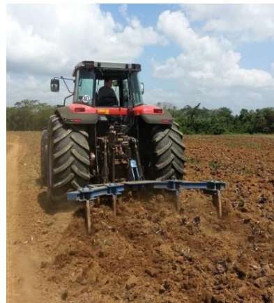
Abbildung 20: Tiefenmeißel bei der Bodenbearbeitung
