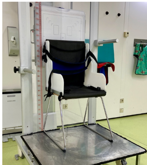
Abbildung 3 Stuhl mit einer, für Röntgenstrahlen durchlässigen, Rückenlehne und Armlehnen. Spezialanfertigung der Firma Movimento GmbH in Kassel. (Eigene Abbildung)
