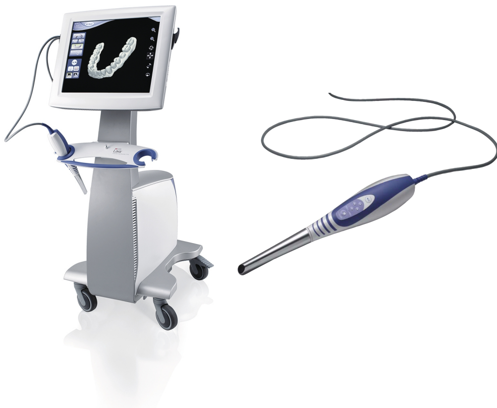
Abb. 10: Lava™ C.O.S-Hardware für die digitale intraorale Abformung. Sie basiert auf dem Prinzip des „active wavefront sampling“. 3M ESPE AG hat diese Technologie als „3D-in-Motion-Technologie“ bezeichnet.
