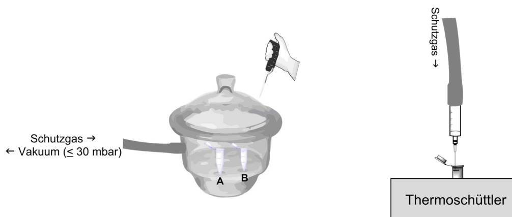
Abbildung A.1: Allgemeiner Versuchsaufbau der Probenvorbereitung (links) und allgemeiner Versuchsaufbau zur Probenentnahme unter Schutzgasbedingungen (rechts). [1]
