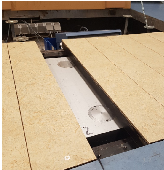
Abbildung 6: Foto einer in den Boden eingelassenen Kraftmessplatte. Der Fußboden ist blau. Die Brückenelemente sind beige. Je nachdem, ob die austauschbaren Brückenelemente der Kraftmessplatte (grau) oder den seitlichen Halterungen (schwarz) auflagen, wurde die Kraft des Probanden auf die Kraftmessplatte übertragen oder nicht. So konnte gewährleistet werden, dass jede Kraftmessplatte genau einen Fußkontakt abbildet.
