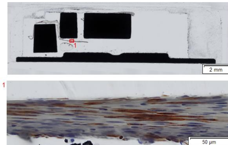
Abbildung 14: ProSa Ventil (Miethke) im Längsschnitt mit Anti-GFAP Färbung und Ausschnitt (1)
