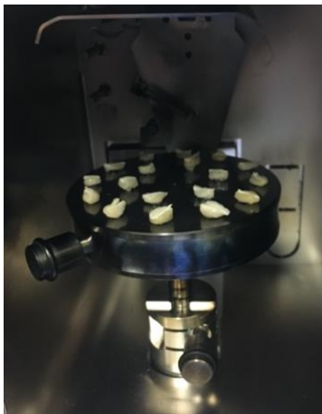
Abbildung 10: Proben im Fein- vakuum zur Besputterung
