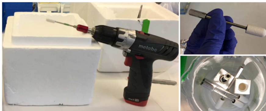
Abbildung 2.1: Cryo-Grinder und Akkuschauber für die mechanische Lyse von Ratten-Ischias-Nerven: Die Styroporbox diente als Behältnis für den flüssigen Stickstoff. Hierin wurden die Mörser platziert und die Ratten-Ischias-Nerven innerhalb der vorgekühlten Mörser durch Drehung des Mörserstabs mittels Akkuschauber homogenisiert.
