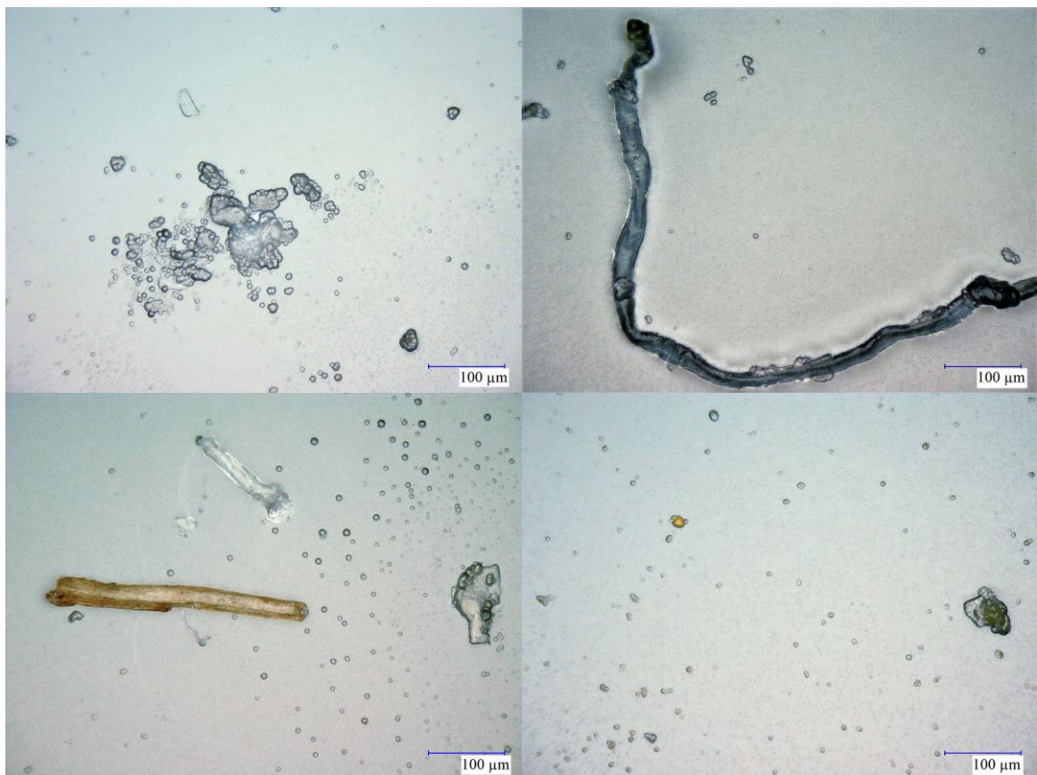
Abbildung 43: Mikroskopbilder der Parylene-Metall-Multilayerproben auf Glasobjektträgern. In den oberen beiden Bildern ist eine aus einer 9 mM \text{CuCl}_2 -Lösung erzeugte plasmabehandelte Metallsalzschrift, welche mit Parylene C beschichtet wurde, abgebildet. Das untere linke Bild zeigt eine Multilayerprobe desselben Schemas, wobei die Metallsalzschrift mit einer \text{FeCl}_3 -Lösung (6 mM) und die Metallsalzschrift im unteren rechten Bild mit einer \text{FeSO}_4 -Lösung (6 mM) erzeugt wurde.
