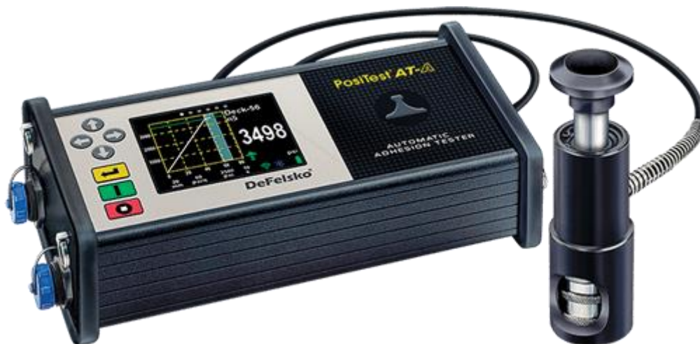
Abbildung 36: Positest AT-A -Gerät [222] mit angeschlossenem Prüfzylinder.
