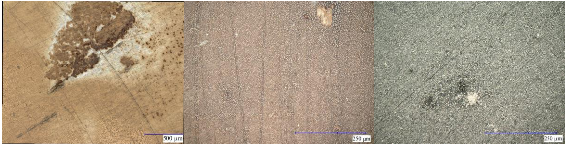
Abbildung 23: Gegenüberstellung der verschiedenen Stadien als Mikroskopaufnahme der reduktiven Patinabehandlung mit einem wasserstoffhaltigem Atmosphärendruckplasma (36.6 kW/L) mit Hilfe der Disc-Jet-Plasmaquelle. Im linken Bild ist die Grenze der Patinaschicht zum Kupferblech als unbehandelte Referenz dargestellt. Das mittlere Bild zeigt die Patina nach einer anfänglichen Behandlung von 10 s und das rechte Bild eine Behandlung von 40 s im stationären Zustand.
