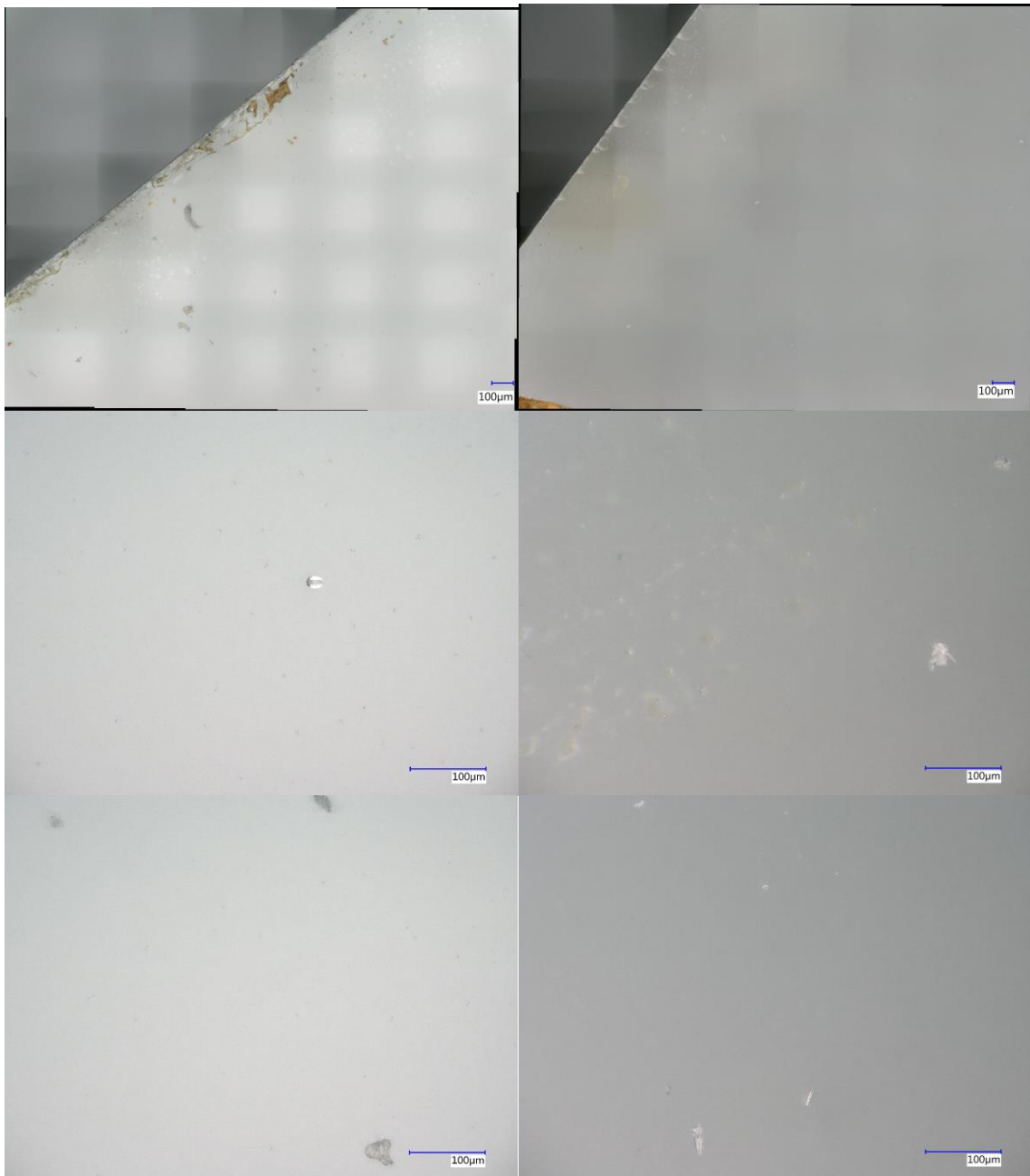
Abbildung A-13: Mikroskopbilderserie der aus einer 0.012 M Lösung aufgetragenen \text{FeCl}_3 -Schichten auf einem Glasobjektträger vor (linke Spalte) und nach einer Varigonplasmabehandlung (rechte Spalte). Hierbei wird die Schicht vom Objektträgerrand (obere Reihe) zur Objektträgermitte (untere Reihe) betrachtet. Es fällt auf, dass die Plasmabehandlung eine signifikante Farbänderung in einigen Schichtbestandteilen hervorrief und dass die meisten und größten kristallinen Strukturen vermehrt am Rand existieren, welche zur Mitte hin kleiner und seltener werden.
