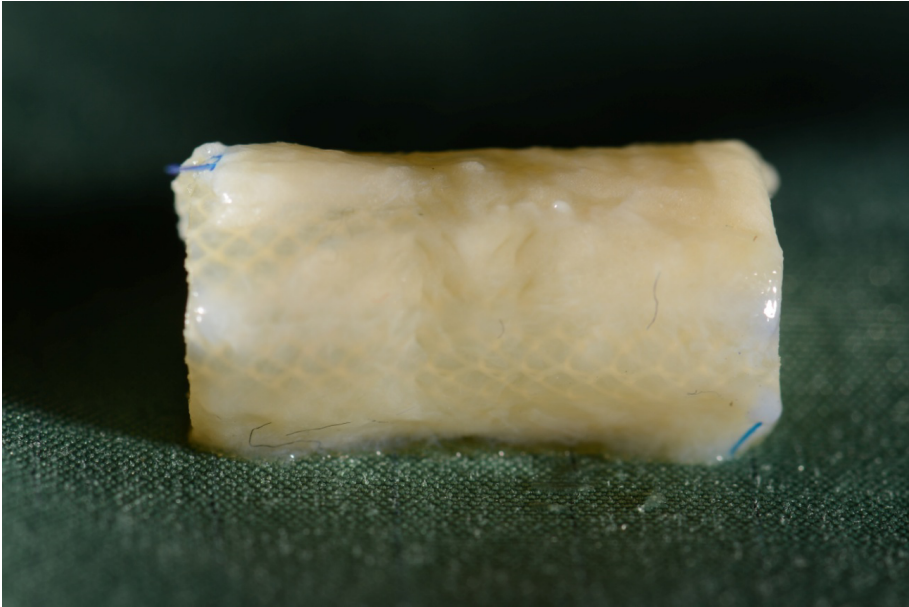
Abbildung 16: Makroskopischer Klemmabdruck einer Fogarty-Klemme. Auf der Omniflow-II-Prothese sichtbare Klemmabdrücke eines Softjaw-Klemmeinsatzes, Präparat C3Z.
