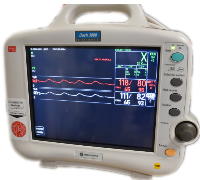
Abbildung 7: Monitor zur Drucküberwachung. Die Abbildung zeigt einen pulsatilen Fluss mit einer Frequenz von 65/min. Die rote Linie stellt den Druck vor den Prothesen und die weiße Linie den Druck in der Umleitung bei geklemmten Prothesen dar.
