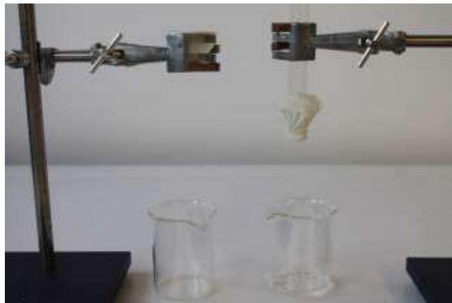
Abbildung 32 - Versuchsaufbau und Beobachtung: Das Wasser durchdringt die Tischtennisballschicht nicht (links), durch die Membran tropft das Wasser hindurch (rechts).
