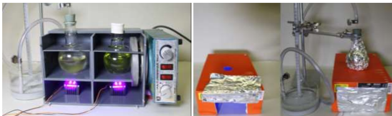
Abbildung 11 – Versuchsausrüstung mit jeweils einem Reaktionskolben für die Wasserspaltung und die Aktinometrie (links), Low-cost Versuchsaufbau (rechts).
