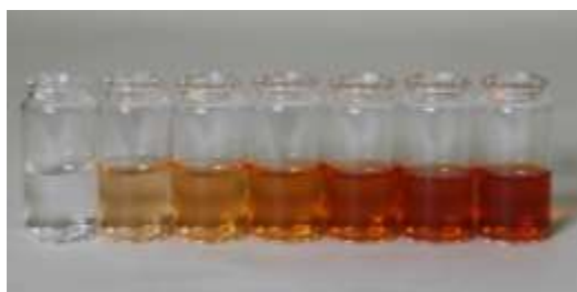
Abbildung 13 - Sieben Lösungen unterschiedlicher Eisen(II)-phenanthrolin-Konzentration zur Anfertigung einer Kalibrierungskurve.
