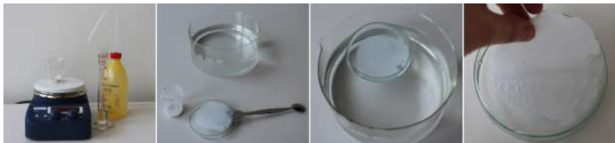
Abbildung 30 - Membranherstellungsschritte: Einschmelzen des Tischtennisballs (links), Auftragen der zähflüssigen Tischtennisball/Aceton-Mischung (zweite von links), Fällen der Membran im Wasserbad (zweite von rechts), Ablösen der Membran (rechts).
