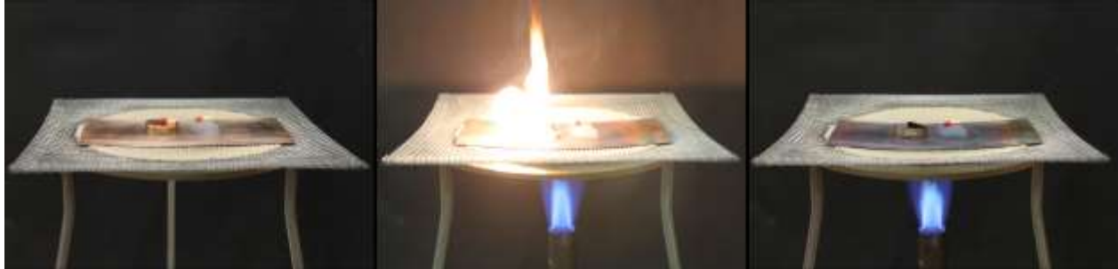
Abbildung 7 - Experiment Wärmeisolation zu Versuchsbeginn (links), zum Zeitpunkt der Streichholzentzündung (mittig) und 15 Minuten nach der Entzündung (rechts).
