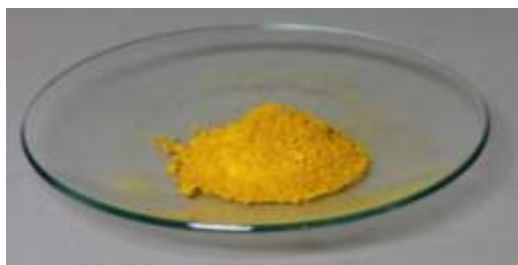
Abbildung 16 - Getrockneter Feststoff, Photokatalysator aus Cadmium- und Zinksulfid.
