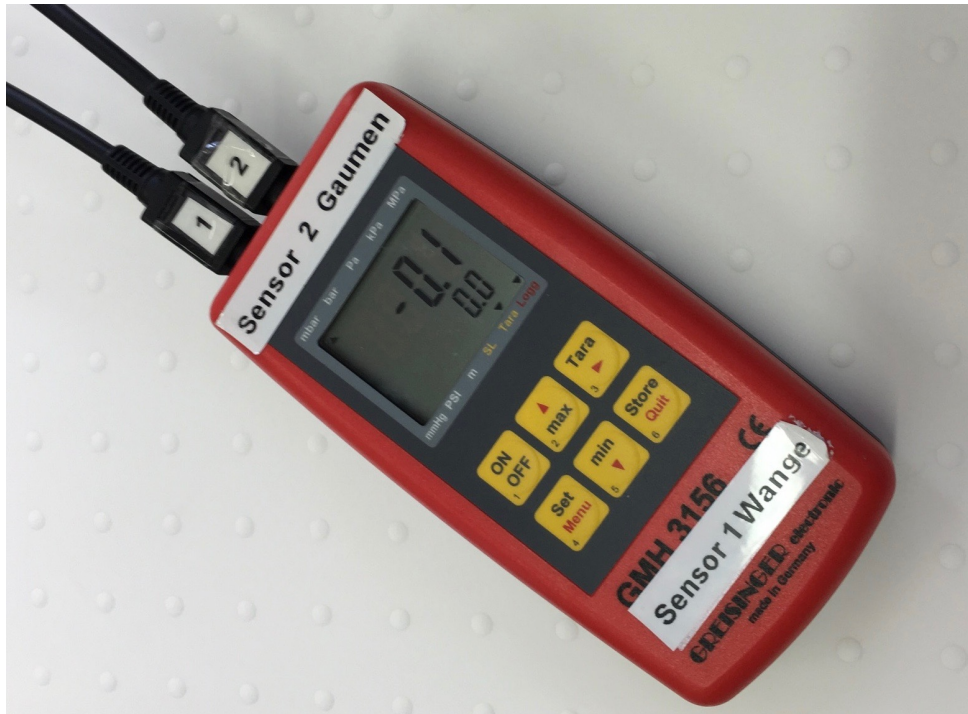
Abbildung 10: Messgerät: Präzisionsdruckmessgerät (GMH 3156)
