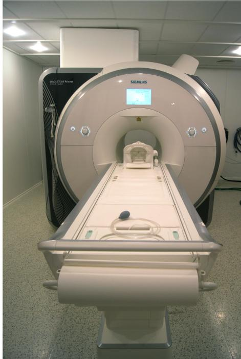
Abbildung 1: 3 Tesla MRT (Magnetom Prisma Fit, Siemens Healthcare, Erlangen, Deutschland) mit ausgefahrener Patientenliege und integrierter 32-Kanal-Rückenspule im Vordergrund und 64-Kanal-Kopfspule. Foto mit freundlicher Genehmigung von Irene Böttcher-Gajewski, Max-Planck-Institut für Biophysikalische Chemie Göttingen, 2016.
