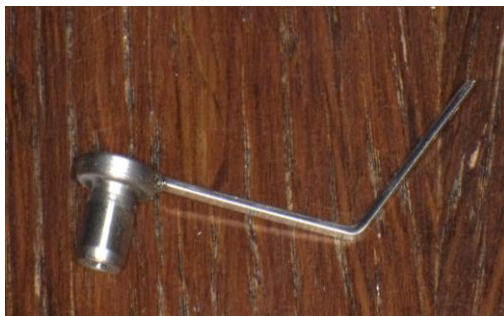
Abb.2.10: modifizierte Innenbuchse mit angelasertem Haltegriff
