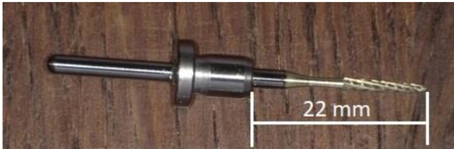
Abb.2.12: Genormte Lindemann-Fräse mit angelaseter Bundbohrbuchse
