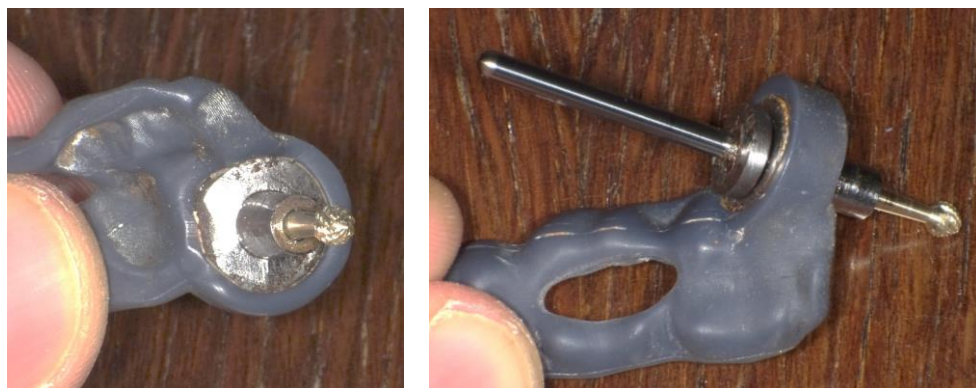
Abb.2.20: Konzeption der Umsetzung der Erweiterungsbohrung links: exakte Passung der angelaserten Buchsen des Rosenbohrers durch die Außenhülse rechts: Tiefenstopp durch Anschlag der angelaserten Bundbohrbuchse an der Außenhülse
