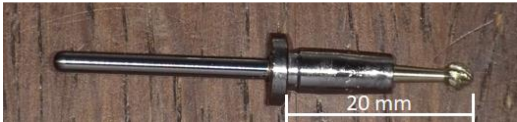
Abb.2.13: Genormter Rosenbohrer mit angelaseter zylindrischer Bohrbuchse & Bundbohrbuchse
