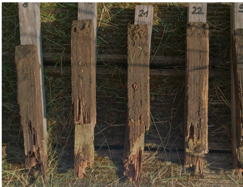
Abbildung 84: Unbehandelte Referenzprüfkörper (Buchen-LVL) nach 2 Jahren im Erdkontakt (EN 252, 2015).
