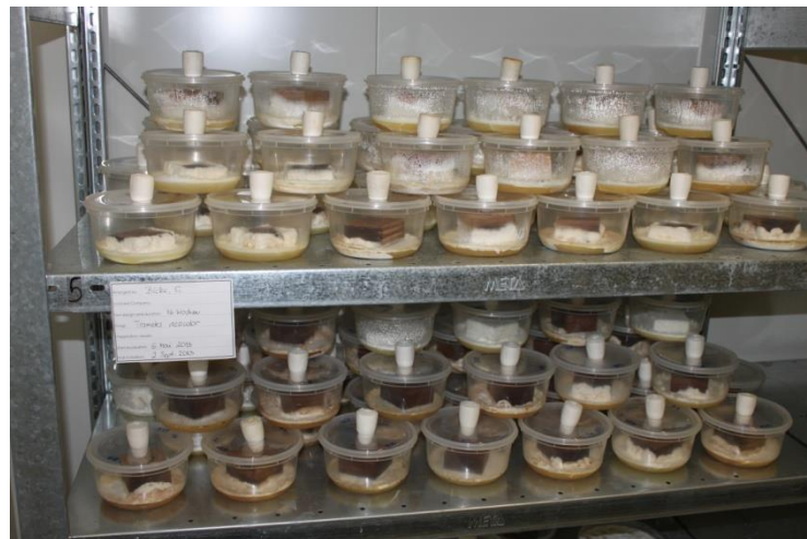
Abbildung 24: Buchen-LVL-Prüfkörper während der Inkubation auf Trametes versicolor im Prüfraum bei 22±1°C und 70±5% relativer Luftfeuchte.
