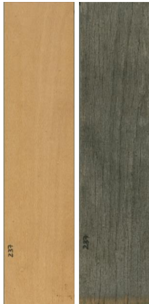
Abbildung 148: Unbehandeltes Buchen-LVL mit 2 N/mm 2 Pressdruck, vor (links) und nach einer 12-monatigen Bewitterung (rechts).
