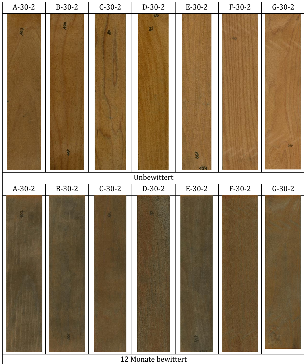
Abbildung 168: Oberflächen von Buchen-LVL mit unterschiedlichen Harztypen (A, B, C, D, E, F, G) bei einem WPG von 30% und einem Pressdruck von 2 N/mm 2 zu Beginn und nach 12 Monaten der Bewitterung in Anlehnung an EN 927-3 (2006).
