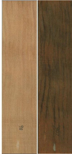
Abbildung 150: Buchen-LVL mit 2 N/mm 2 Pressdruck, modifiziert mit dem Harztyp D bei einem WPG von 48%, vor (links) und nach einer 12-monatigen Bewitterung (rechts).
