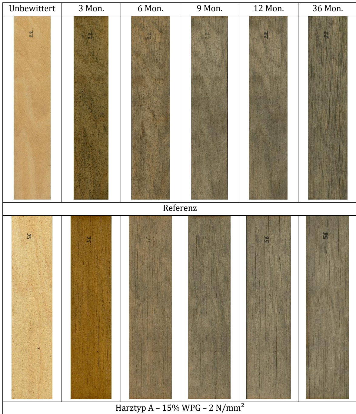
Abbildung 164: Oberflächen von unbeschichtetem Buchen-LVL in Abhängigkeit vom WPG und der Bewitterungsdauer im Freiland in Anlehnung an EN 927-3 (2006) unter Verwendung des Harztyps A und einem Pressdruck von 2 N/mm 2 .
