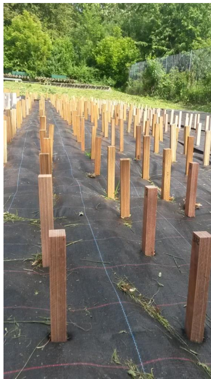
Abbildung 25: Freilandprüfung im Erdkontakt (EN 252, 2015) mit PF-modifiziertem Buchen-LVL in Göttingen.
