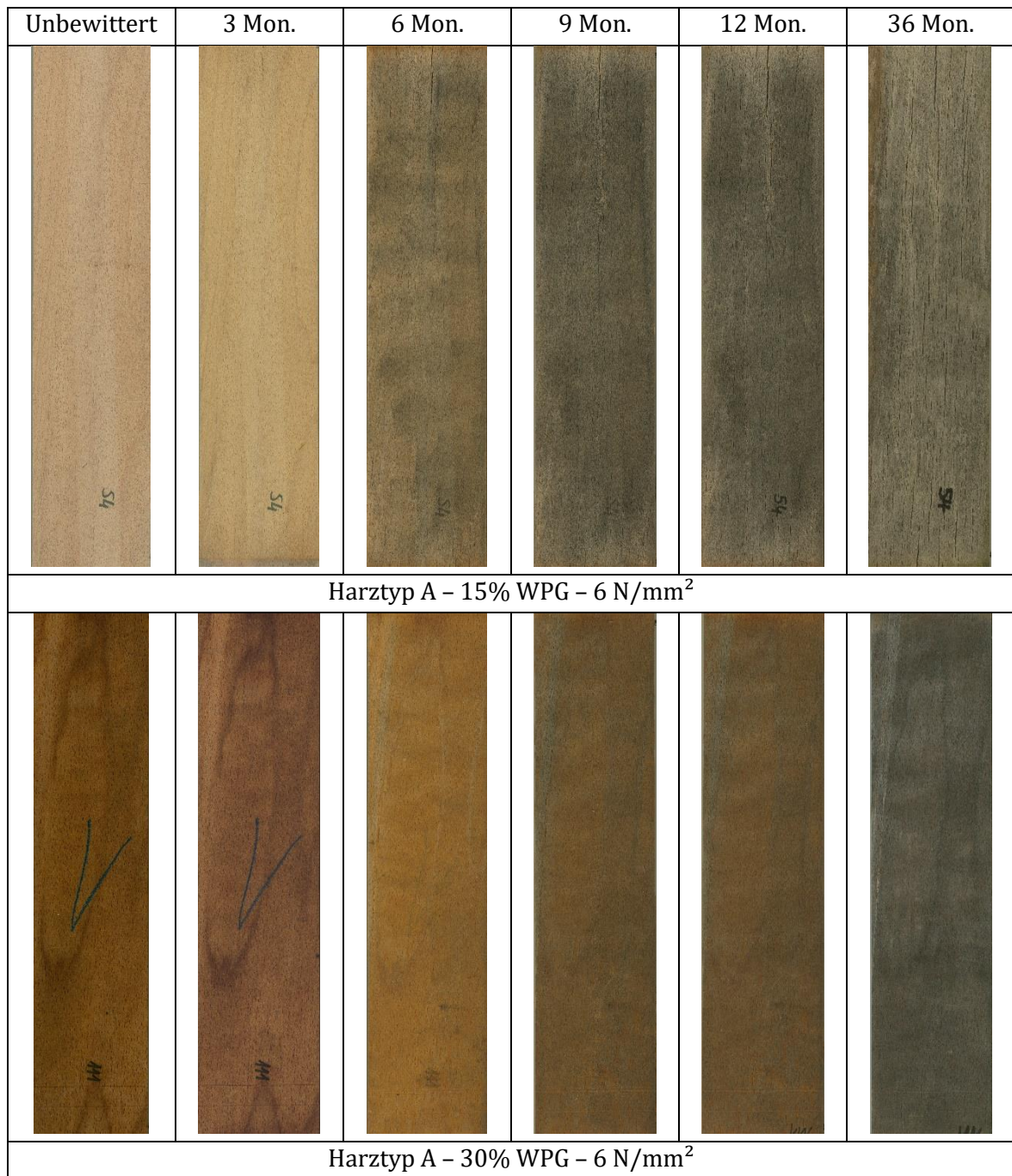
Abbildung 166: Oberflächen von unbeschichtetem Buchen-LVL in Abhängigkeit vom WPG und der Bewitterungsdauer im Freiland in Anlehnung an EN 927-3 (2006) unter Verwendung des Harztyps A und einem Pressdruck von 6 N/mm 2 .
