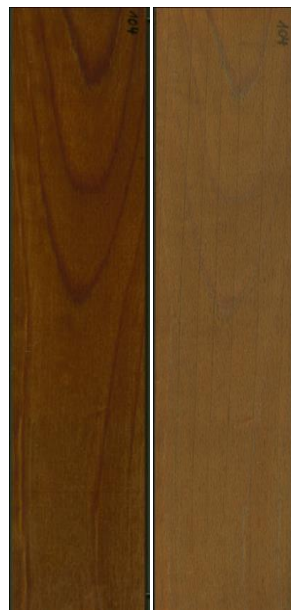
Abbildung 149: Buchen-LVL mit 2 N/mm 2 Pressdruck, modifiziert mit dem Harztyp B bei einem WPG von 60%, vor (links) und nach einer 12-monatigen Bewitterung (rechts).
