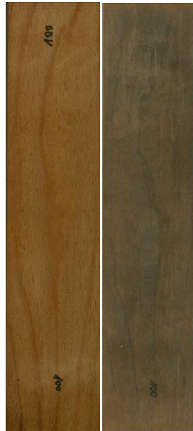
Abbildung 156: Buchen-LVL mit 2 N/mm 2 Pressdruck, modifiziert mit dem Harztyp B bei einem WPG von 30%, vor (links) und nach einer 12-monatigen Bewitterung (rechts).
