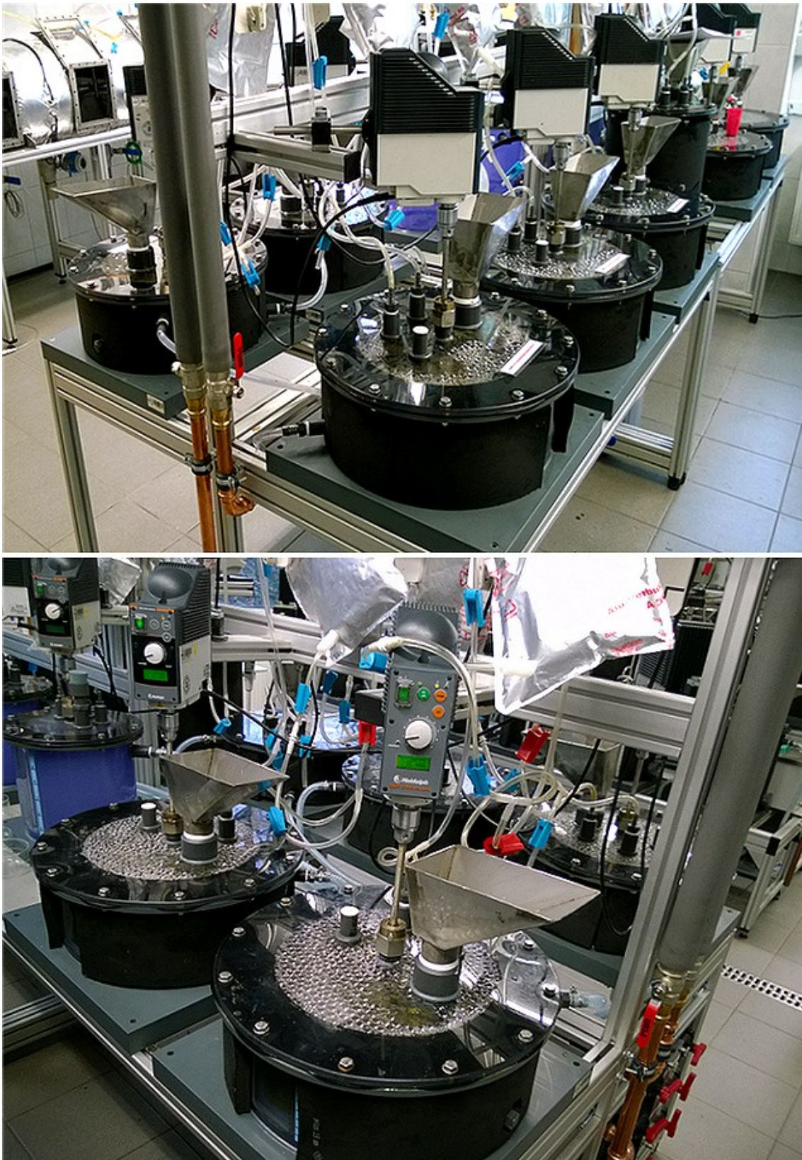
Abbildung 7: Fotoaufnahmen der fünf am DBFZ (quasi)kontinuierlich betriebenen Versuchsbiogasreaktoren (R 4.5 bis R 4.9), die im Verbundprojekt benutzt wurden.
