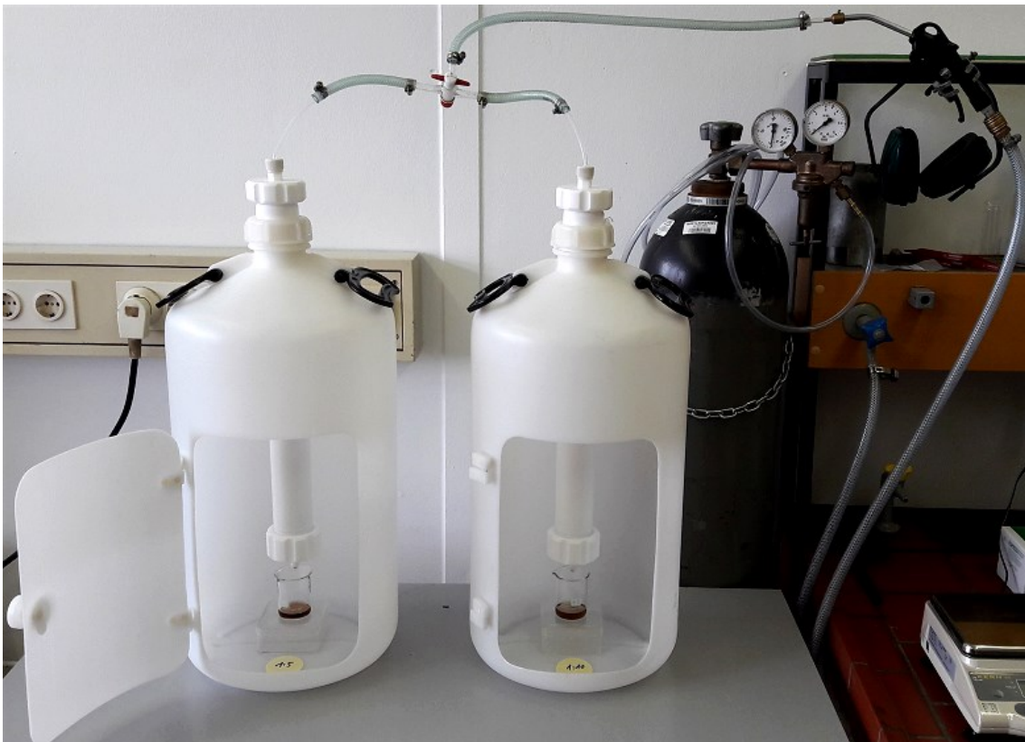
Abbildung 99: Fotoaufnahme von zwei Teflon-Filtrationsapparaturen mit Filtraten ( < 0,45 \mu\text{m} ) einer Fermenterprobe in den beiden Verdünnungsstufen 1:5 (links) und 1:10 (rechts).
