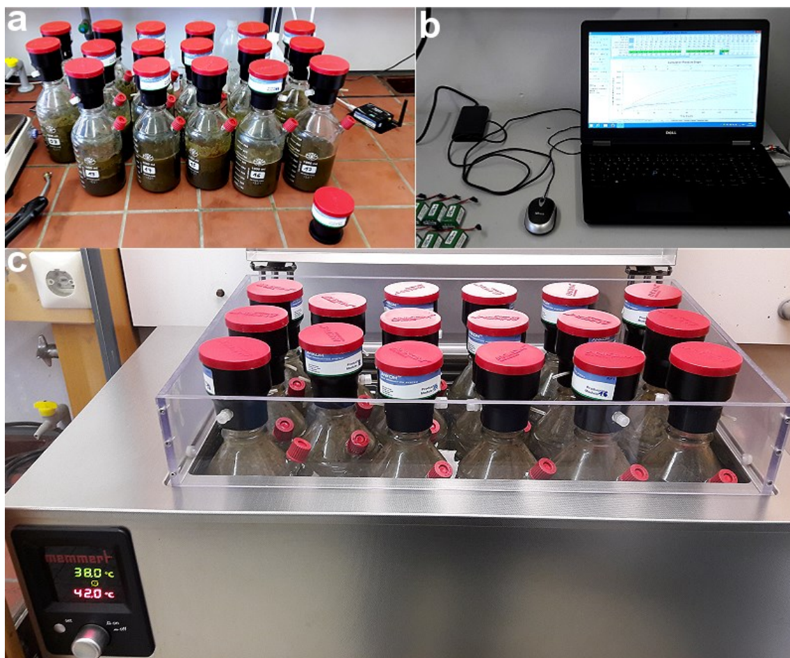
Abbildung 85: Fotoaufnahmen eines diskontinuierlichen Gärversuchs auf Basis des Oberhausen-Rostock-Göttinger Aktivitätstests (ORGA-Test). a) Für eine Testreihe vorbereitete Gasbildungsmodule, vorne rechts: Referenzmodul zur Überwachung und Aufzeichnung des aktuellen Atmosphärendrucks, hinten rechts: Basis-Koordinator (RF-Modem) zur Kommunikation zwischen den Gasbildungsmodulen, dem Referenzmodul und der Aufzeichnungssoftware; b) Software zur Datenaufzeichnung; c) Schrägansicht auf die Gasbildungsmodule im Wasserbad.
