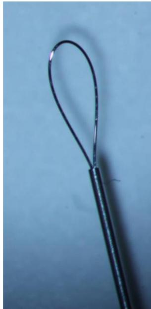
Abbildung 11: Darstellung der Drahtschleife des FragRemovers
