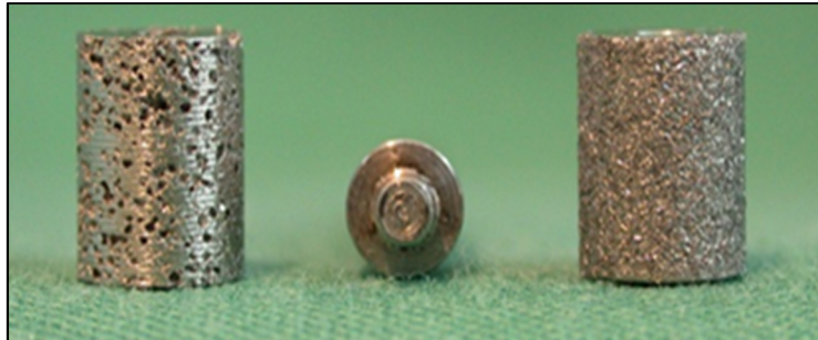
Abbildung 2.1.2-1 Testimplantate Aristotech für Implantationsversuche am Kaninchen. Poröses (links) und gestrahltes (rechts) Ti-6Al-4V-Implantat.
