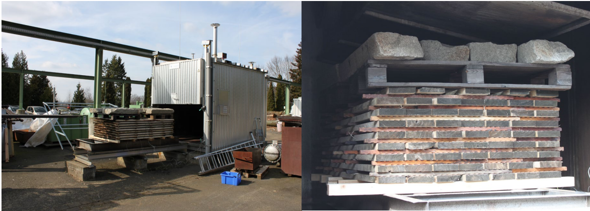
Abbildung 4-1: Trockner Übersicht (links) und Kiriholz in Trockenkammer (rechts)
