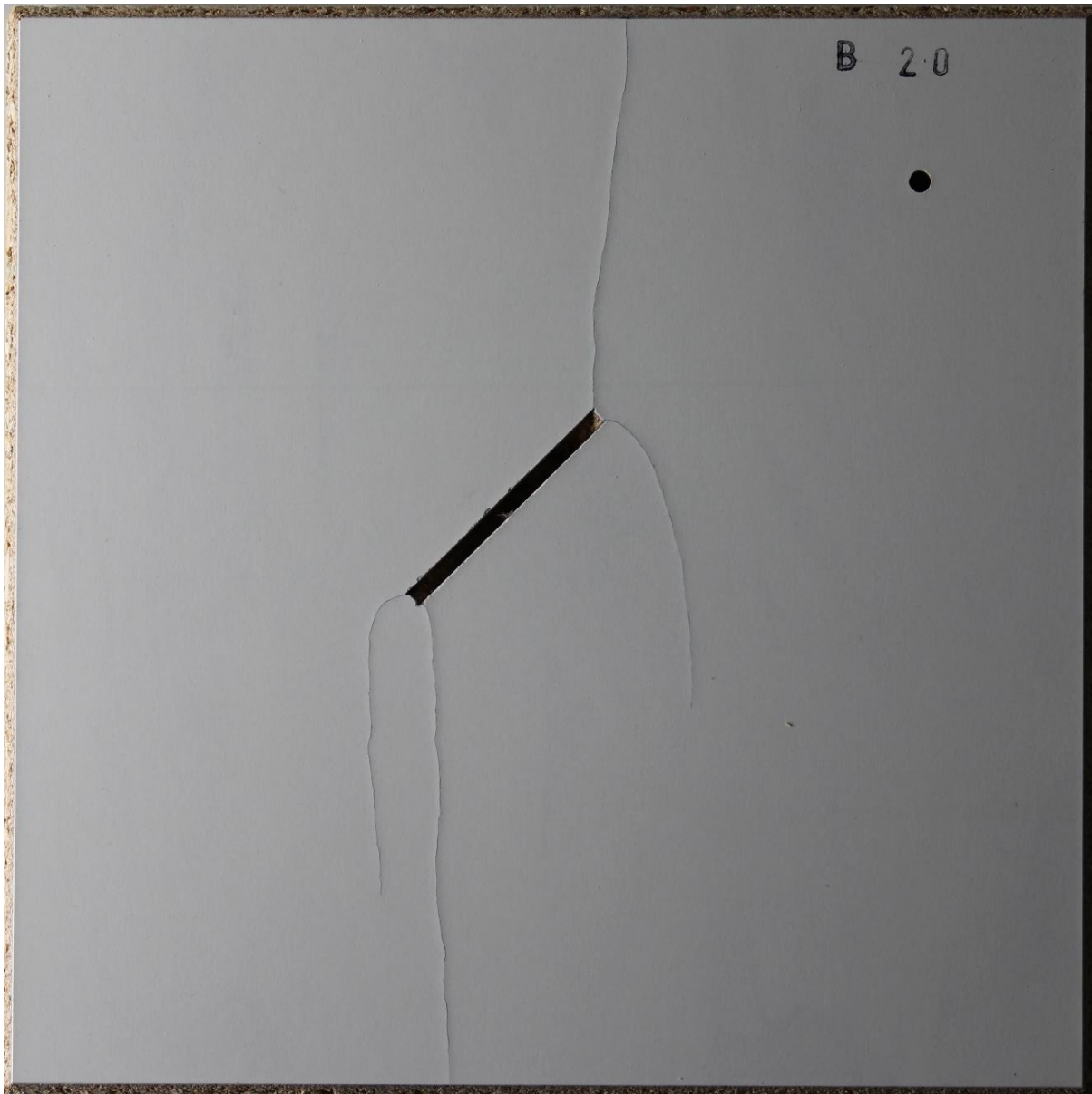
Abbildung 53: Aufnahme einer 2-Blättrigen Probe nach der Rissanfälligkeitsprüfung.
