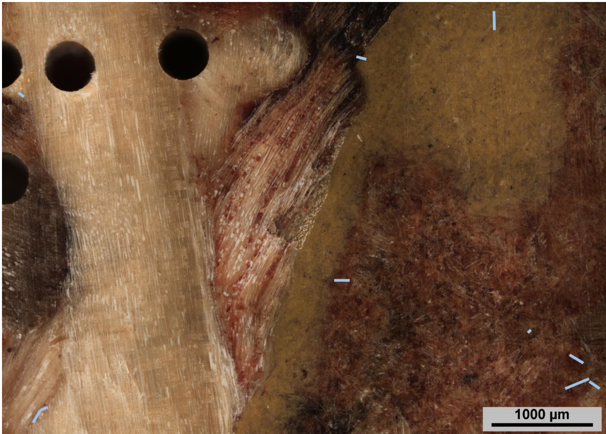
Abbildung 71: Mikrorissprojektion bei der Grobspanplatte.
