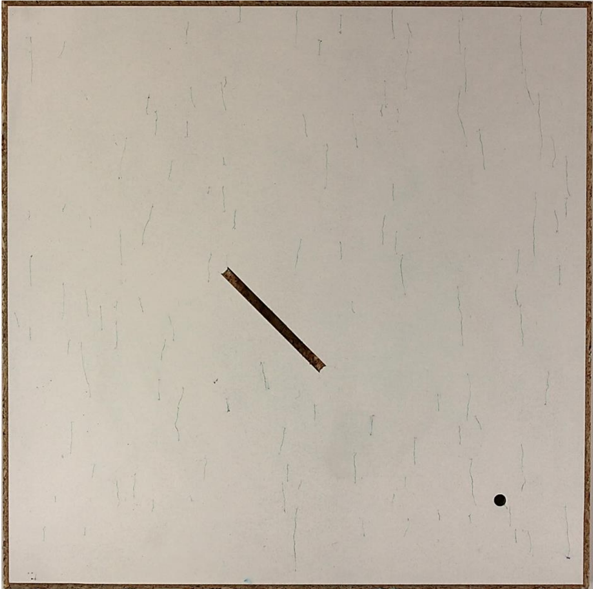
Abbildung 31: Stark überhärtete Probe (25 cm x 25 cm) mit schnell härtendem Harz nach der Rissanfälligkeitprüfung. Risse sind zur Kontrastierung angefärbt.
