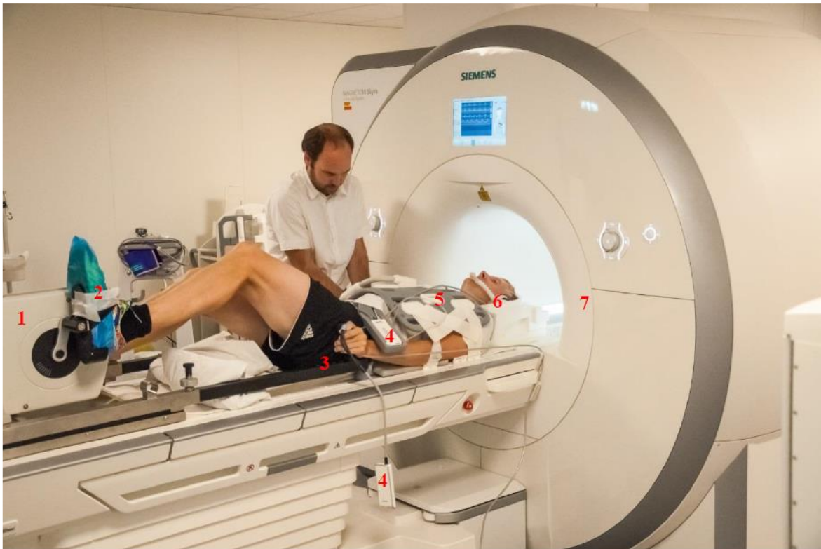
Abbildung 1: Versuchsleiter am Real-Time-MRT-Scanner mit einem Probanden im Fahrradergometer. Von links nach rechts im Bild: 1 MRT-taugliches Fahrradergometer, 2 Fixierung der Füße des Probanden, 3 Haltegriffe, 4 Puls- und EKG-Monitoring, 5 Körperspule, 6 Headset mit Mikrofon, 7 Real-Time-MRT-Scanner Siemens Skyra 3T.
