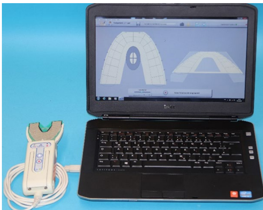
Abbildung 11: Anwendungseinheit des T-Scan-III-Systems. Bestehend aus Sensorhandstück, Software (Tekscan, South Boston, USA) und Laptop Dell Latitude E5430 (Dell Inc., Texas, USA).
